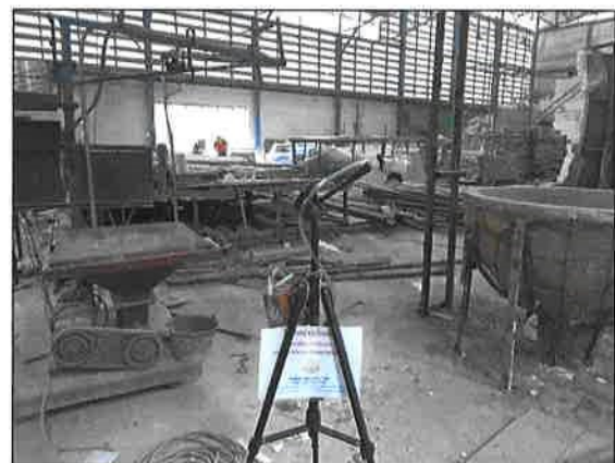
โรงงานผลิต GRC : บริเวณกลาง Line โรงไม่ ตรวจวัด Total Dust
