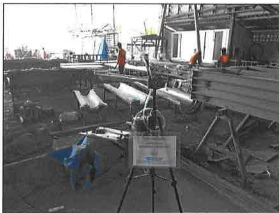
โรงงานผลิต GRC : บริเวณกลาง Line โรงผลิต ตรวจวัด Total Dust
